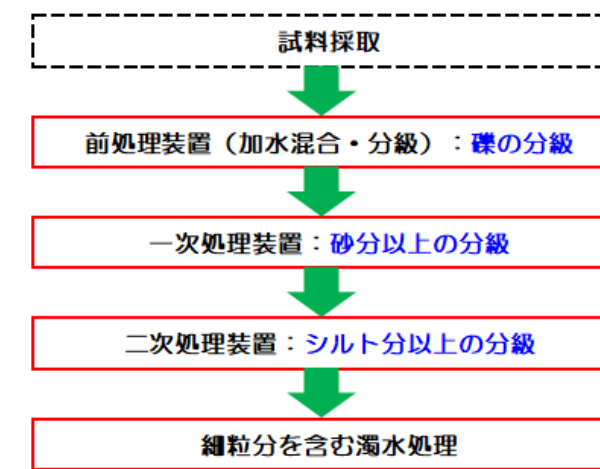
図-1.4 分級処理フロー
